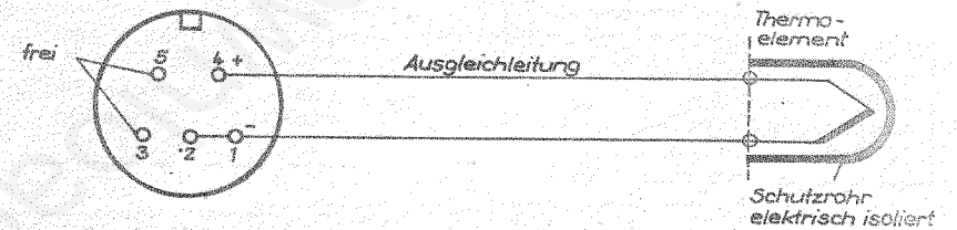
2. Anschlußbelegung unedles Thermoelement Ni Cr - Ni Al, Fe - Cu Ni, Fe - Ko
